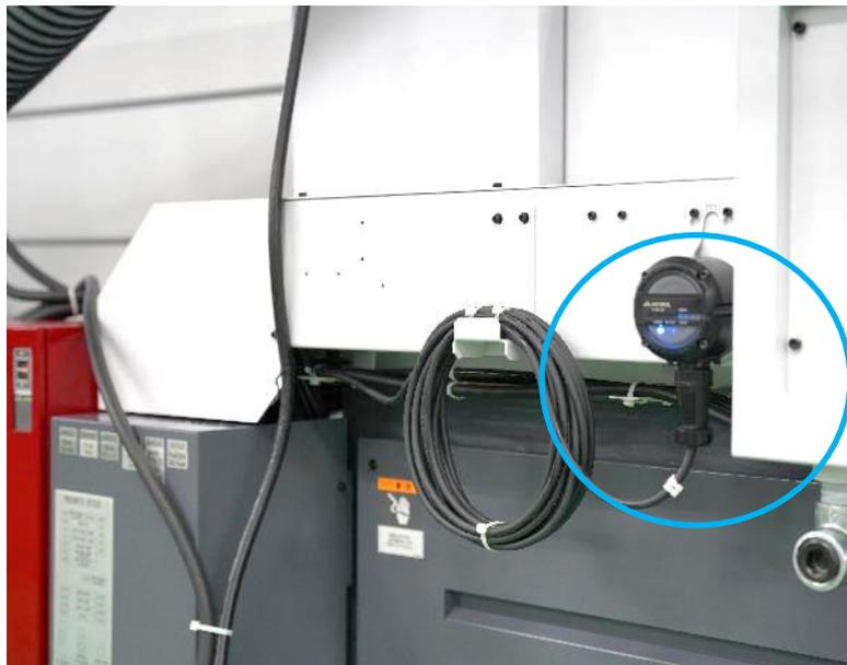
工作機械が20台稼働する環境下で、通信エラーの発生なく、その測定精度は他社品同等を確認
